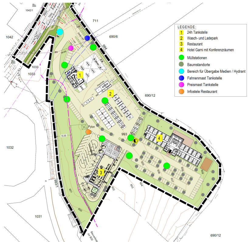
Lageplan zum „Vorhabenbezogenen Bebauungsplan Abfahrt B 30 Nord“. Links im Bild Anschlussast Bad Waldsee-Nord der B 30 mit der K 8033. (Grafik: Planwerkstatt a.B. Langenargen)
